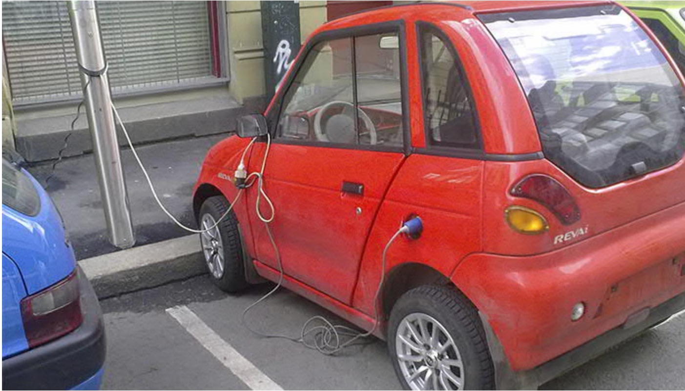
Skjøteledning på ladekabel (Foto: Jostein Grav/DSB)
